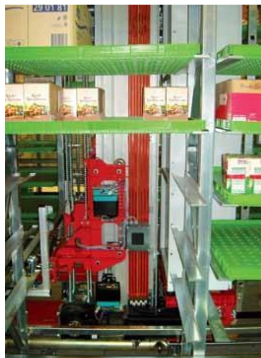
Мачтовый способ монтажа (Продактор-7 полюсов)
